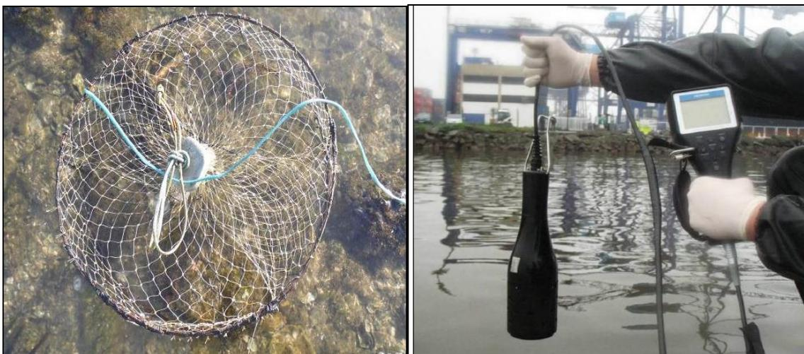
Figura 2. Gaiola e sonda multiparâmetros utilizadas para coleta dos decápodes.
